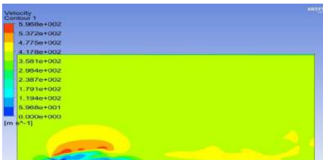
شکل ۵-۲۳. نتیجه مدل‌سازی جریان باد در ANSYS تحت زاویه شیب ۳۰ درجه و زاویه افقی ۱۲۰ درجه
